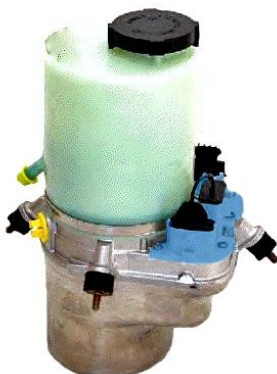
ELECTROHIDRÁULICO - SISTEMA ELECTRÓNICO: BUS CAN
