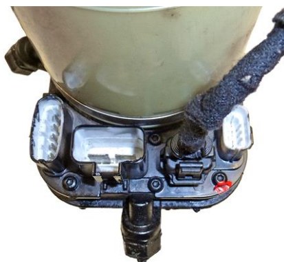
ELECTROHIDRÁULICO - SISTEMA ELECTRÓNICO: BUS CAN
