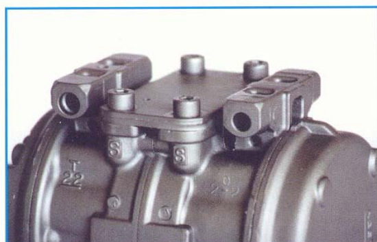
Figura 1. Racores juntos em torreta.
